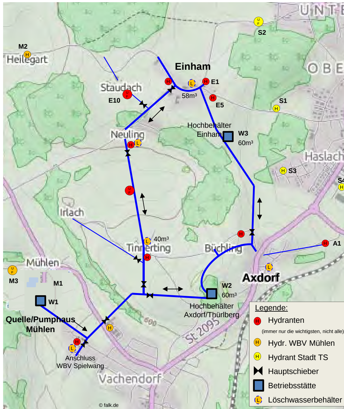
Versorgungsschema des Wasserbeschaffungsverbands Axdorf-Einham-Neuling-Staudach
